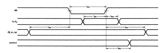
Figure 27. MODE 0 (Basic Output)
